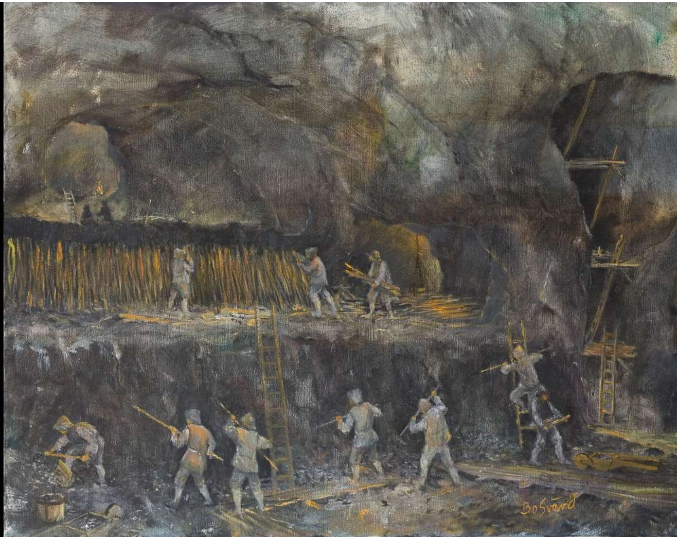
Pallbrytning. Eldning och brytning sker trappstegsvis en gång i månaden, från vägg till vägg i berggrummet. Enorma mängder ved åtgår.
