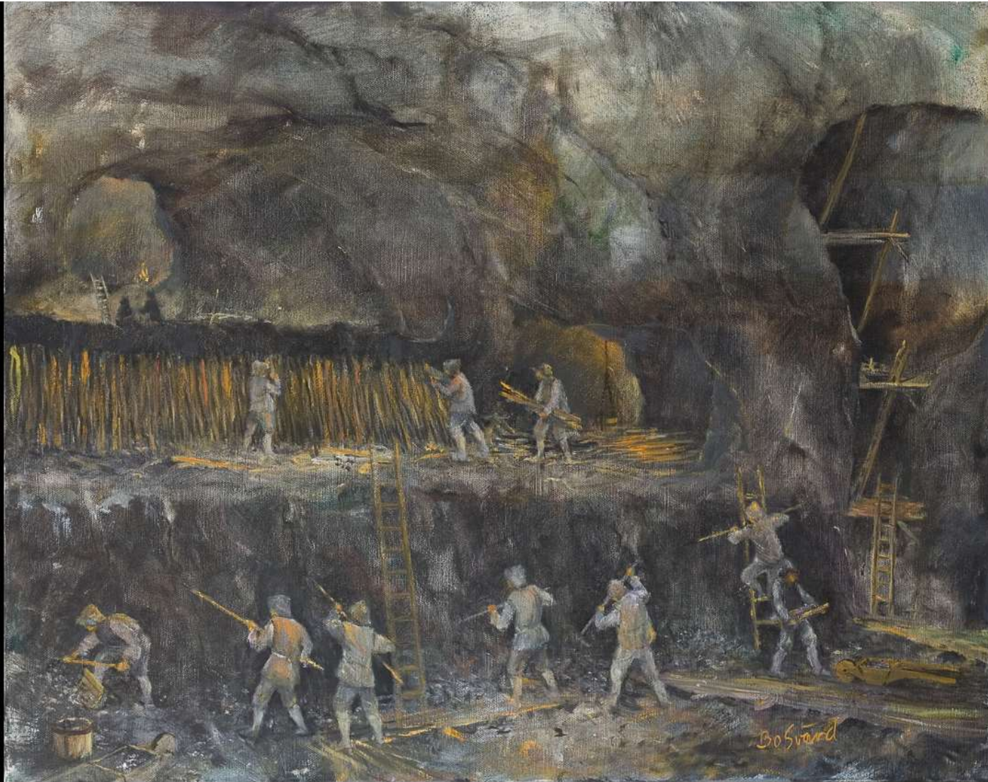
Pallbrytning. Eldning och brytning sker trappstegsvis en gång i månaden, från vägg till vägg i bergrummet. Enorma mängder ved åtgår. Oljemålning.
